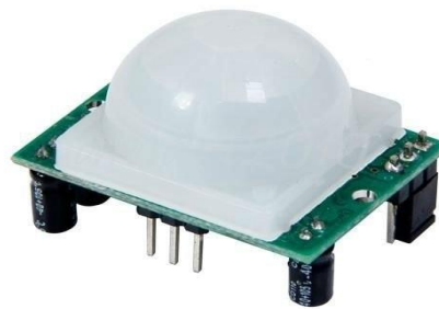
Внешний вид устройства Размер печатной платы 32x24мм
